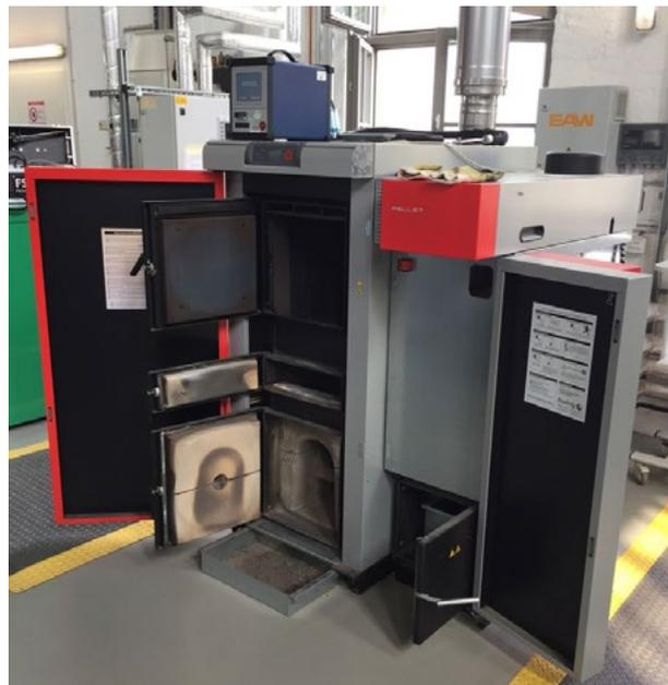
Abb. 3: Versuchsanlage zur Verbrennung von Stückholz und Pellets, [3]
